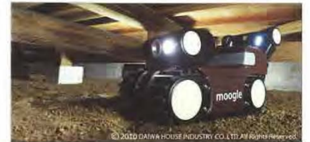
遠隔操作で床下をチェック
