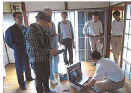
筋かい探知器を使って筋かいの位置を確認し、非破壊調査の有効性を検証
