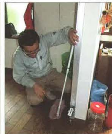
計測器を使い壁の傾きを計測する坂本大志氏
