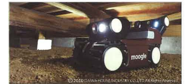
遠隔操作で床下をチェック
