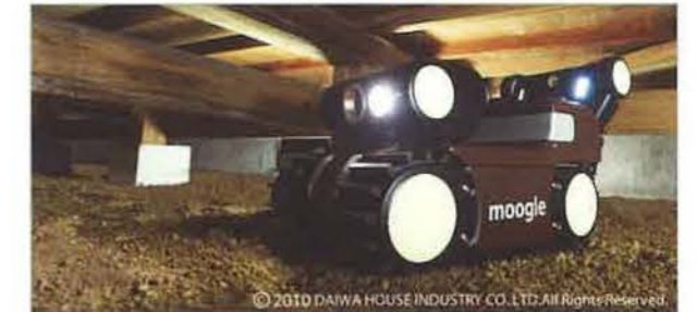
遠隔操作で床下をチェック
