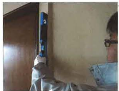
壁や床で使う水平器はホームインスペクションの必需品
