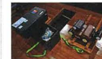
狭小空間点検ロボを講堂の床下に入れてリモコンで走行させ、カメラが捉えた映像をスクリーンに投影(大和ハウス工業)
