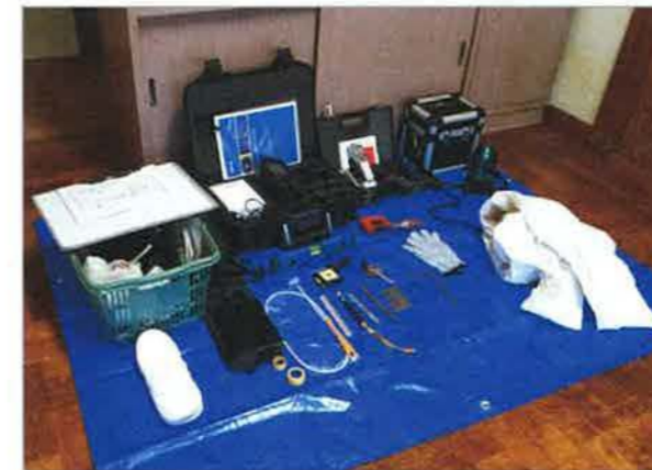
講師が持ち込んだ診断道具類(順不同)：オートレーザー、水平器、含水率計、赤外線照射温度計、赤外線サーモグラフィカメラ(二次診断用)、打診棒、テストハンマー、さげ振り、防汚服、形状・材質の違う各種クラックスケールなど
